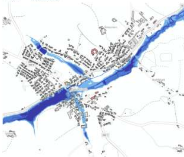
Abbildung 18 Hochwassergefahrenkarte HQ100 - Lastfall F90
